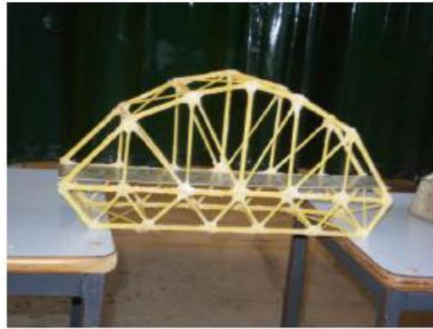
Σχ. 1 Παράδειγμα γέφυρας «σπαγγέτι» τύπου δικτυώματος.
